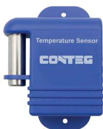
Teplotní senzor pro umístění dovnitř do rozvaděčů snímá teplotu s rozsahem -55 °C až +75 °C. Lze napojit až 8 senzorů v řetězovém zapojení na jeden inteligentní port. Senzor je napájen z hlavního zařízení. Prodloužení se provádí pomocí standardního kabelu LAN CAT 5/6. Maximální délka prodloužení kabelu je 150 m pro 8 čidel.
