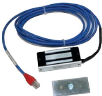
Malý elektromagnetický zámek dveří s přídržnou silou 700 N, což odpovídá 70 kg, je vhodný pro rozvaděče, kde nemůže být nainstalována elektronická klika značky CONTEG. LED indikace zámku zobrazuje stav odemčeno, zamčeno, otevřeno nebo vniknutí. Napájen z hlavní jednotky.
