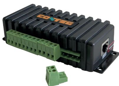
S expandérem je možné vytvořit 8 vstupů/výstupů na jediném inteligentním portu hlavní řídicí a monitorovací jednotky. K tomuto expandéru je možné připojit na vstupním kontaktu jakýkoliv typ spínacího dveřního kontaktu (např. RMS-MK-01). Zařízení je automaticky rozpoznáno a napájeno z hlavní jednotky. Připojení se provádí pomocí standardního kabelu LAN CAT 5/6. Maximální délka prodloužení kabelu je 300 m.
