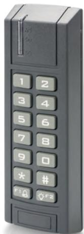
Podsvícená klávesnice se zabudovanou čtečkou karet (EM formát) umožňuje autorizaci pomocí karty samotné na 125 kHz nebo kombinaci karty s 4místným kódem. Snadné připojení k přístupové jednotce dveří RDU pomocí kabelu s barevně označeným konektorem RJ-45. Čtečka je vybavena bzučákem a LED signalizací pro indikaci stavu. Vhodná pro instalaci do vnitřních prostor. Nízká energetická spotřeba, v běžném stavu 65 mA. Napájení z hlavní jednotky.
