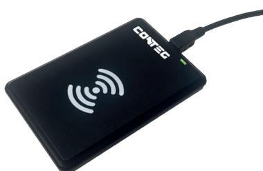
Stolní duální čtečka k PC je užitečným příslušenstvím pro administraci karet uživatelů v aplikaci CONTEG Pro Server. Pracuje na frekvenci 125 kHz a 13.56MHz. Je schopna pracovat s 125 kHz identifikačními přístupovými médii. Disponuje LED signalizací a bzučákem. Připojuje se k USB portu počítače, odkud je zároveň napájena.
