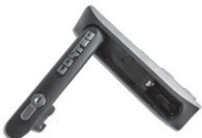
Elektronická klika je umístěna na dveřích samotného rozvaděče se standardním montážním otvorem 25 × 150 mm. Kliku s polo-cylindrickou vložkou lze otevřít pomocí klíče. Může být osazena na dveře s vícebodovým i jednobodovým zamykacím mechanismem. Na těle kliky je umístěna LED signalizace indikující stav – odemčeno, zamčeno, otevřeno a vniknutí. Klika disponuje nízkou energetickou spotřebou, v běžném stavu méně než 50mA a v pracovním režimu méně než 250 mA, a je napájena z hlavní jednotky.
