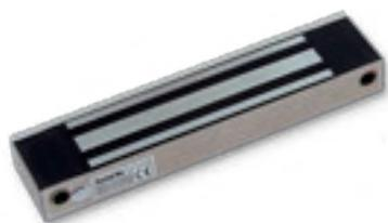
Vodotěsný elektromagnetický zámek dveří s přídržnou silou 3500 N, což odpovídá 350 kg, je vhodný k instalaci na vstupní dveře. LED indikace zámku zobrazuje stav - odemčeno, zamčeno, otevřeno nebo vniknutí. Napájen z hlavní jednotky.
